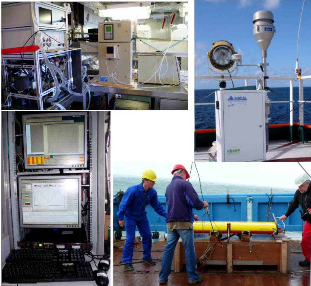
Oben links: GKSS FerryBox (links) mit externen Nährstoffanalysatoren (rechts). Oben rechts: DIGITEL enviro-sense Aktivsammlersystem für Luftchemie. Unten: ScanFish (rechts) mit Bord- und Steuereinheit (links).
