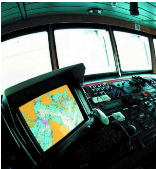
Einsatz von ECDIS an Bord (mit freundlicher Genehmigung von PRIMAR)
