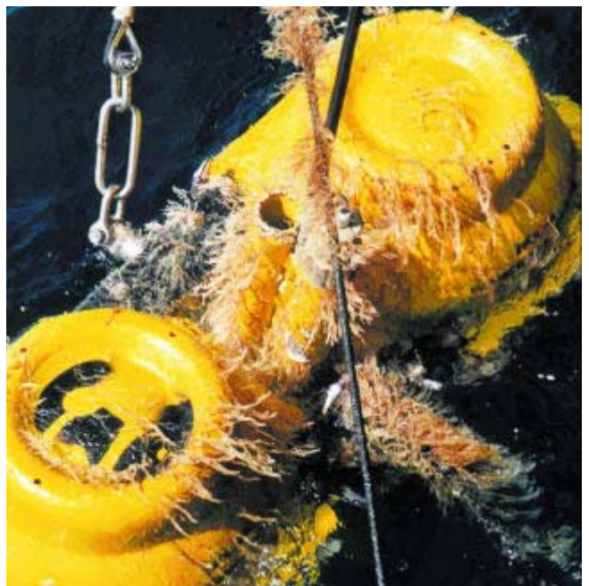
Nach einem Jahr in der Tiefsee hat sich spärlicher Bewuchs am Auftrieb angesiedelt
