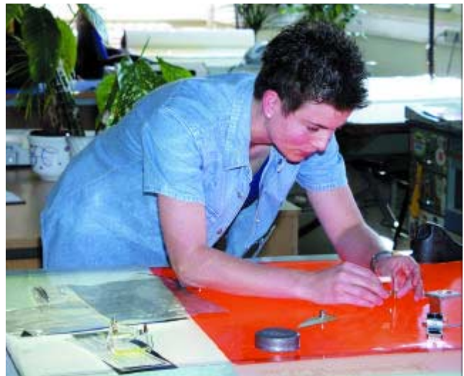
Kartographin bei der Karten-Originalherstellung durch Gravurtechnik
