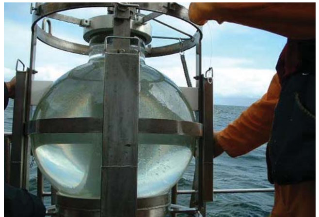
Ausbringen eines 100-Liter-Glaskugelwasserschöpfers Deployment of 100-litre glass bowl samplers
