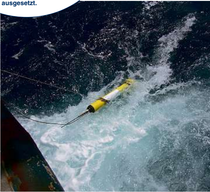
ARGO-Float wird im Nordatlantik ausgesetzt.
