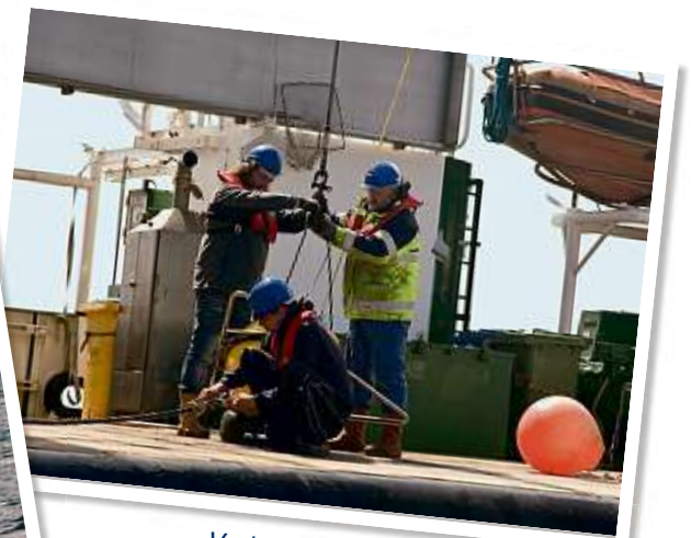
Vorbereitung zur Aussetzung einer Seegangsboje (waverider)
