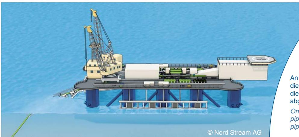
An Bord des Verlegeschiffes werden die Rohre zusammenschweißt und die Pipeline auf den Meeresboden abgesenkt
