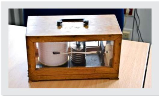
Barometer: Messgerät zur Bestimmung des Luftdrucks
