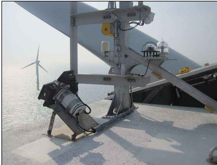
Abbildung 6.3: Installiertes Infrarot-Kamerasystem (VARS) auf der Gondel der Anlage R4 im Windpark „alpha ventus“
