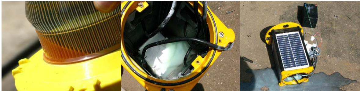
Abbildung 9.3: SLC 310 Lampe, nach Ausbringung und Verlust an Position 21, äußerlich waren keine Schäden feststellbar
