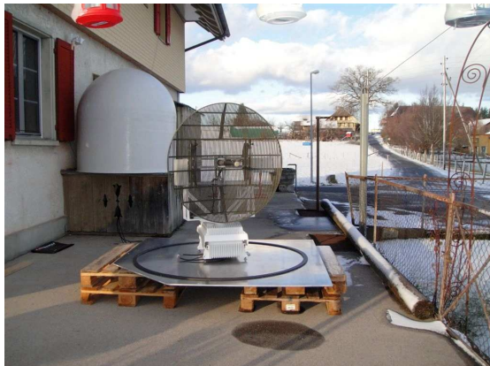
Abbildung 7.1: Fixed beam Radar im Freilandtest (links) und aufgezeichnetes Flügel-schlagmuster zur Arterkennung (rechts).
