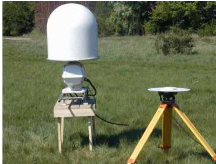
Abbildung 5.3: Positionen der Radarantenne und der SAPOS-Antenne (Quelle: LGN)
