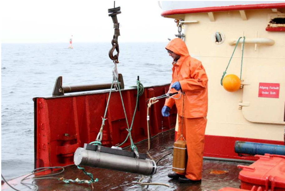
Abbildung 10.1: Auslegen eines Schallmessgerätes etwa 16 km westlich von alpha ventus im FFH-Gebiet Borkum-Riffgrund. In dem röhrenförmigen Gehäuse befinden sich die Aufnahmeelektronik und Batterien. In der Hand des Mitarbeiters: Hydrofon mit Schutzkorb und daran befestigtem Auftriebskörper aus druckfestem Schaumstoff.
