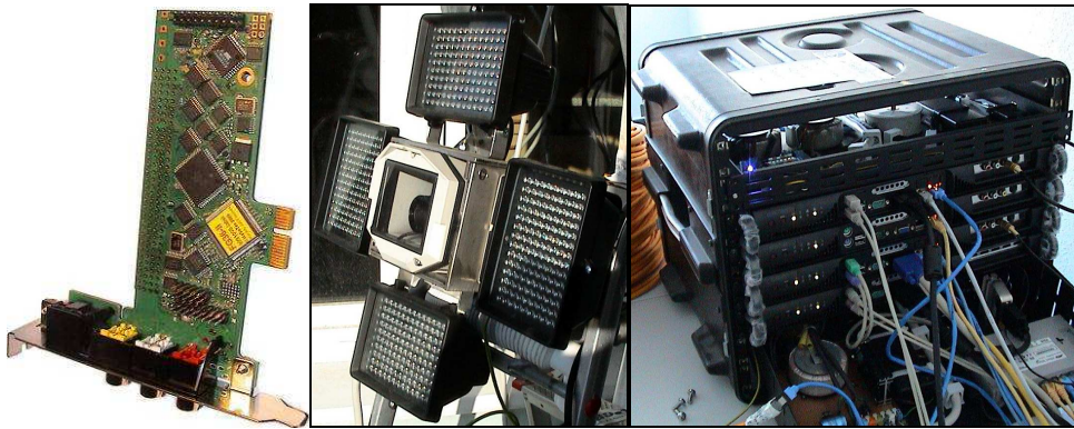
Abbildung 6.2: Kameramodul, Computermodule und Framegrabber FG-36-II PCIe.
