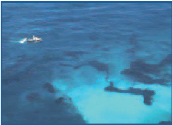
Abb. 8: Anwendung von Dispergatoren: 1. ineffektiver Einsatz bei Schweröl, gekennzeichnet durch die milchige Verfärbung des Wassers ausgelöst durch den Dispergator und die unbeeinträchtigten schwarzen Ölflecken und 2. effektiver Einsatz von Dispergatoren auf Rohöl (ITOPF 2005, Foto: AEA Technology)
